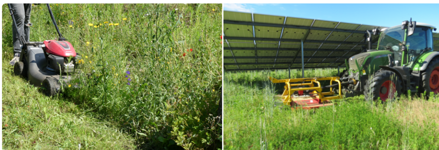
Abb. 7: Bei kleinen Saumbereichen sind auch handgeführte Sichelmulcher nutzbar (links). Bei großen Flächen ist der Einsatz von Großtechnik (Sichelmulcher rechts) geeigneter.
