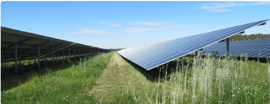
Abb. 18: Das Freistellen der unteren Modulkante vermeidet die Beschattung der Module.
