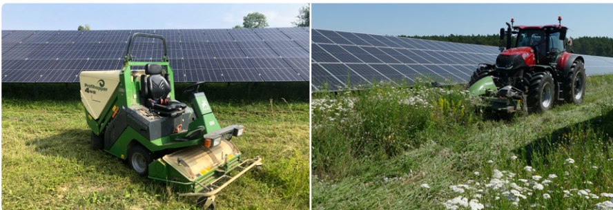
Abb. 16: Mahd durch Schlägelmähwerk bei großen Flächen – direkte Mahdgutaufnahme (links) und Mahd mit Frontmähwerk eines Traktors bei sehr großen Flächen – Trommel-/Sichelmähwerk, für nachträgliche Mahdgutaufnahme (rechts).
