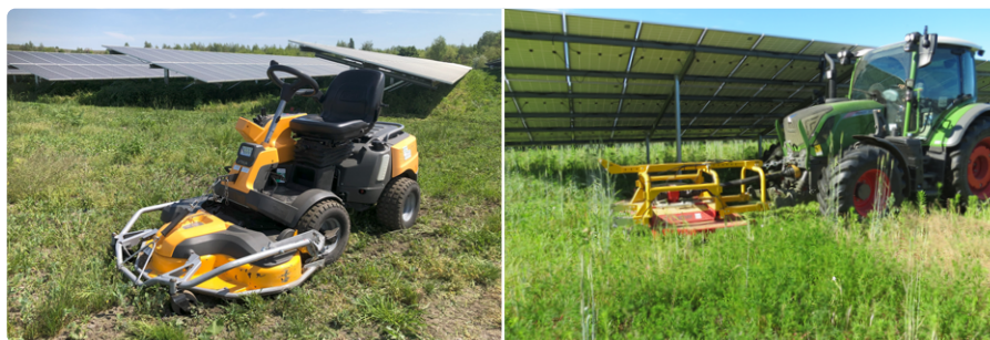
Abb. 13: Sichelmulcher für kleine Flächen (links) und Sichelmulcher für große Flächen (rechts).
