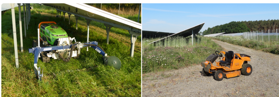
Abb. 21: Funkgesteuerte Mähraupe – Doppelmessermähwerk, nachträgliche Mahdgutaufnahme (links) und Aufsitzmulcher/Sichelmulcher (rechts) zur Pflege der von Modulen übershirmten Bereiche.
