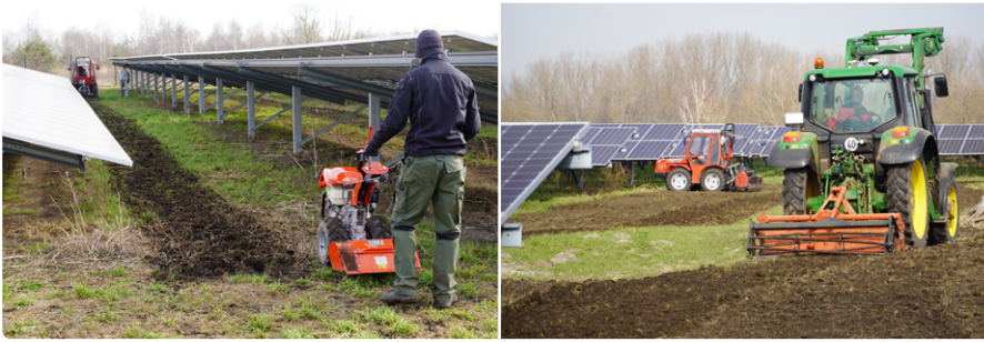
Abb. 4: Handgeführte Bodenfräse bei kleinen Flächen und engen Wendekreisen (links) und Traktoren mit Umkehrfräsen für große Flächen und weite Modulreihenzwischenräume (rechts).
